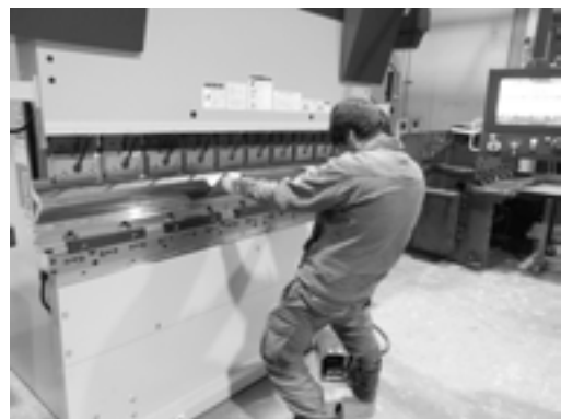
長尺折曲機での作業の様子
