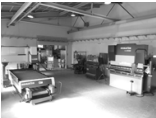
補助金を活用して導入した2次元CO2レーザー加工機と長尺折曲機
