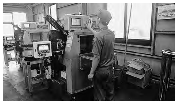
自社開発の自動供給装置と取り付けたNC旋盤
