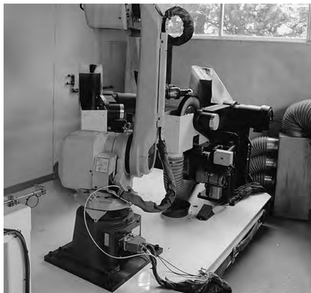
知能ロボットを用いた自動研磨システム
