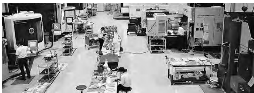
航空機部品専用工場。現在、5軸マシニングセンタなどの大型工作機械が9台稼働し、主翼部品や機体部品の製造している
