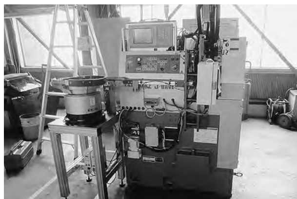
今回導入したNC旋盤と自社開発の自動供給装置
