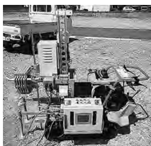
全自動スウェーデン式サウンディング試験機「ウルトラサーチUR-3型 特殊仕様」
