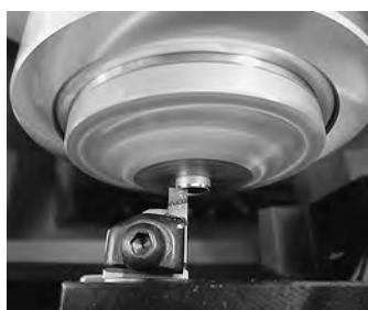
NC旋盤で旋削中のストッパーピストン
