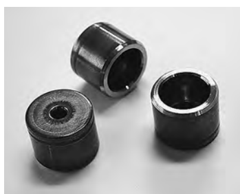
ストッパーピストン。 左が旋削前、右が旋削後
