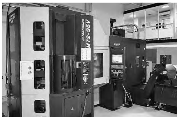
補助金事業で導入された5軸制御立形マシニングセンタ「MAM72-35V」
