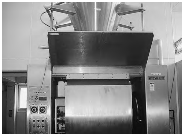
補助金事業で導入した横型高速ミキサー
