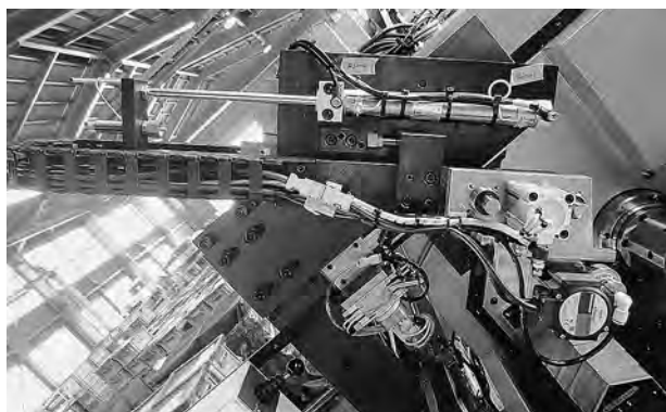
NC旋盤に取り付けた素材の自動供給装置
