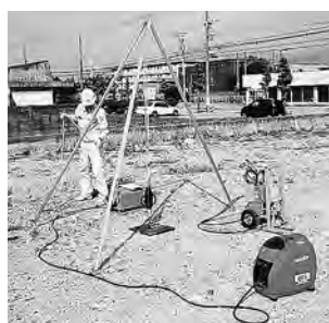
動的回転式サウンディング試験（DSPT）
