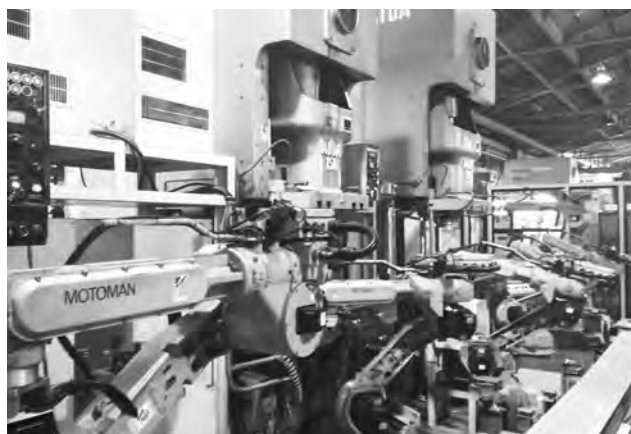
ロボットを導入し無人化を実現した工場のプレスライン（左）と600トンプレス機（右）
