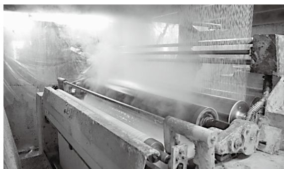
糊付けされる経糸。上部では同時に熱セットドラムで乾燥成型されている
