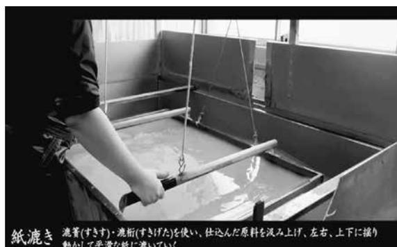
紙漉き 漉簀（すきす）・漉桁（すきげた）を使い、仕込んだ原料を汲み上げ、左右、上下に揺り動かして平滑な紙に漉いていく
