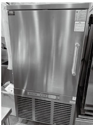
急速冷凍機で余熱取り、冷蔵凝固、ジュレ製造を自動化
