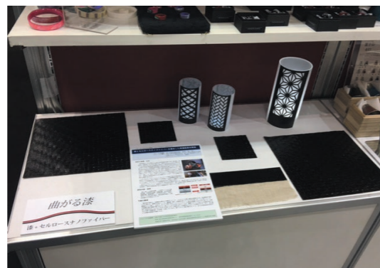
国内最大の見本市で初めて発表された「漆とセルロースナノファイバー（CNF）を複合した高機能素材」による試作品
