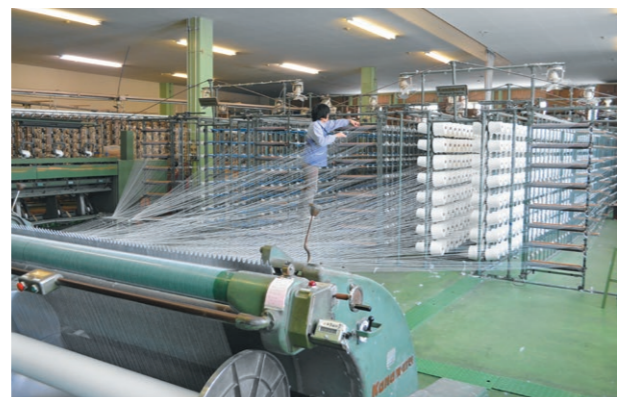
高速度で原糸をビームに巻く整経機
