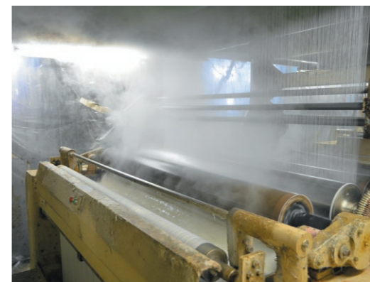
糊付けされる経糸。上部では同時に熱セットドラムで乾燥成型されている
