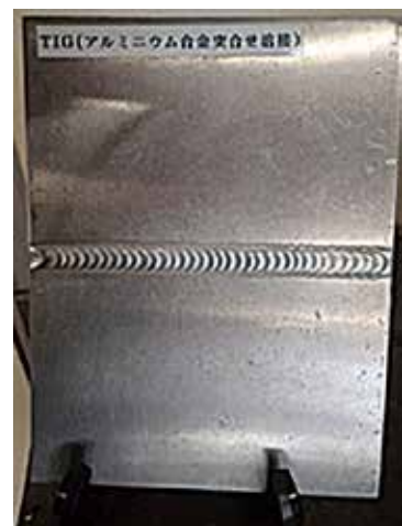
〔薄板突合せ下向き溶接〕
