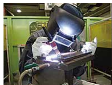
〔治具を用いた下向き突合せ溶接〕
